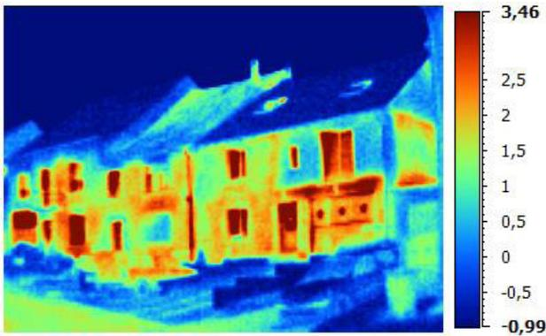
Le manque d'isolation des murs et de la toiture engendre des factures de chauffage élevées.
