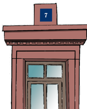
Joli travail de la pierre de taille dans le goût néo-classique au niveau de la porte d'entrée avec son linteau droit mouluré en saillie avec ornementation avec ou sans denticules. Dalle de grès au-dessus de la porte d'entrée indiquant le numéro du logement.
