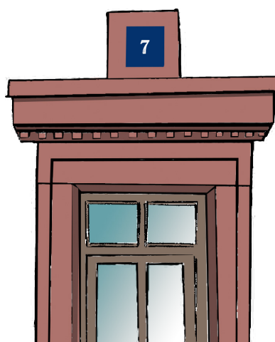
Linteau droit mouluré en saillie de la porte d'entrée, de style néo-classique avec décor à modillons surplombé d'une pierre de forme carré en façade indiquant le numéro du logement
