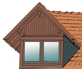
Lucarne jacobine à fenêtre deux battants
