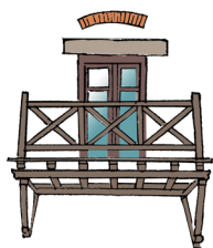
Balcon en bois avec équerre et balustrade à motif en croix de Saint-André
